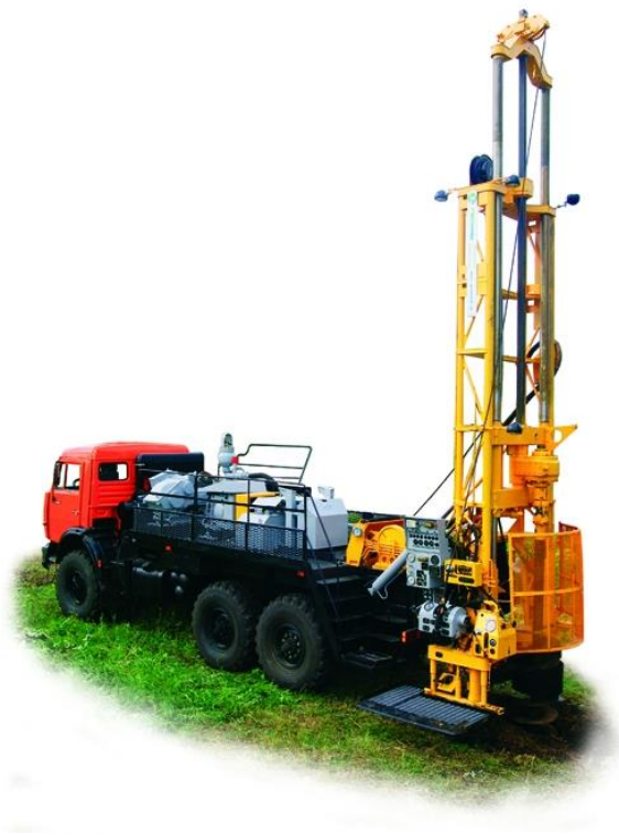
Рисунок 18.1 – Буровая установка ЛБУ-50
