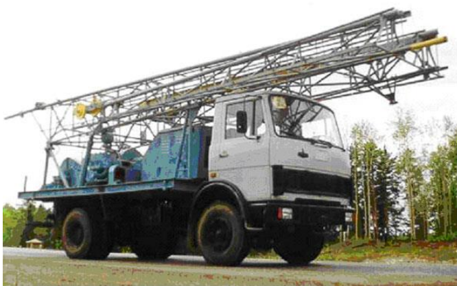
Рисунок 18.5 – Буровая установка УРБ-ЗА3
