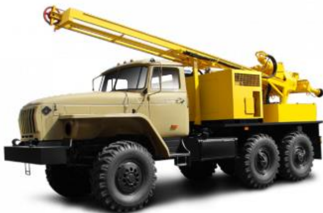
Рисунок 18.3 – Буровая установка УРБ-2А2
